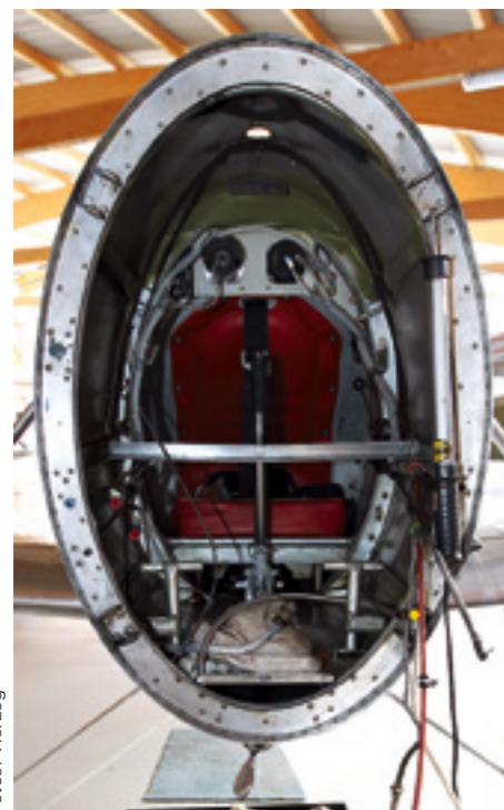
Blick in den Rumpf des ersten in Aluminium-Monocoque-Bauweise gefertigten Serienflugzeugs.
