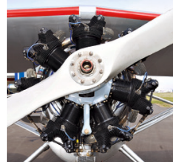
Das nahezu originale Cockpit des ehemaligen Schulflugzeugs, (links). Der Continental Siebenzylinder liefert 164 kW/220 PS (oben). Bärenstark: eines von vielen Hangar-Accessoires.
